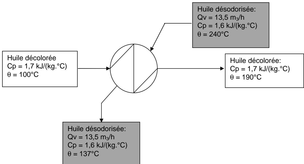
**3.1. Précisez le sens de circulation des flux (co-courant ou contre-courant). Justifiez votre réponse en traçant les profils de températures. (1 pt)**
