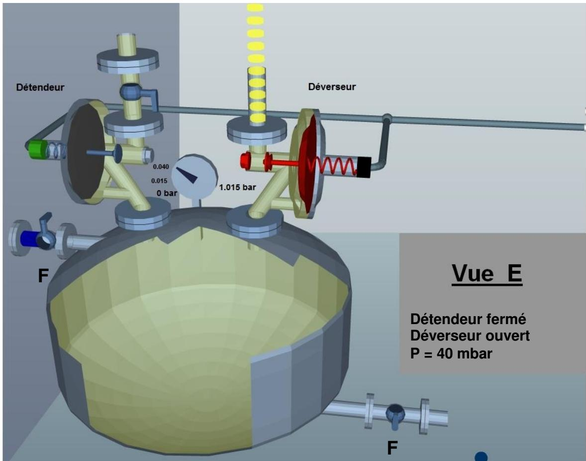
2.1.1.4. À l'aide des données ci-dessous, **calculer** le pourcentage volumique théoriquement obtenu en dioxygène dans le réacteur après l'opération d'inertage réalisée pour l'étape 3 (dossier ressources page 9). **Indiquer et justifier** s'il y a un risque d'explosion.
