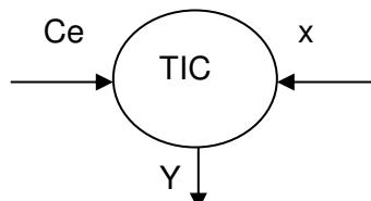
Y : signal de sortie du régulateur
