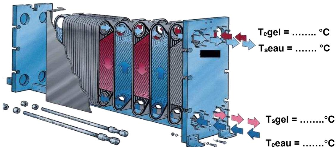
1.4.2. **Préciser** le mode de circulation des fluides dans l'échangeur, à l'aide du schéma précédent.
