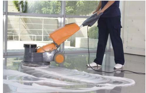
La monobrosse utilisée est vieillissante et son câble électrique est dénudé. L'agent d'entretien laisse agir la solution puis l'aspire à l'aide d'un aspirateur à eau. Ensuite, l'agent rince le sol à l'eau claire et aspire la solution de rinçage. Enfin, il étale plusieurs couches d'émulsion protectrice qui sera utile pour également faire briller le sol.
